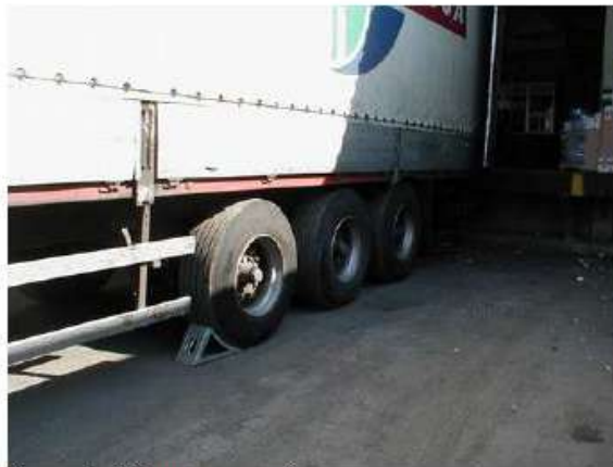
Bloccaggio delle ruote con cunei
